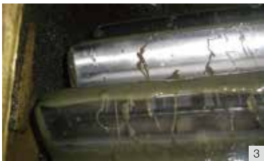
B 磨合润滑 1. 磨合前齿面状况 2. 磨合中(Klüberfluid B-F2 ULTRA 应用实例) 3. 磨合后齿面状况
