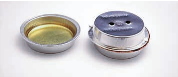
使用模拟链条工作条件的闭口铝盘进行试验
