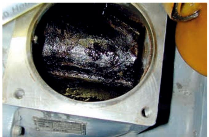
油品在压缩机内部产生的残渣
