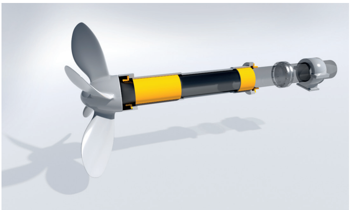
艀轴管中螺旋桨轴、轴承和密封件的典型配置
